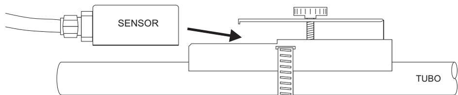
Monte la abrazadera PC3 como se ilustra en tuberías de 0.6" / 15 mm OD o mayores. Bandas de acero inoxidable son incluidas para montajes en tuberías de hasta 32" / 81 cm OD.
