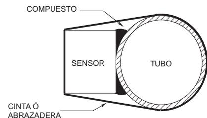
El sensor deberá ser fijado de forma segura a la tubería con material de acople entre la cara del sensor y el tubo. La instalación del sensor con excesiva cantidad de compuesto puede resultar en espacios o vacíos en el compuesto de acople y causar errores o pérdidas de señal. Si no se aplica suficiente compuesto puede crear condiciones similares.
