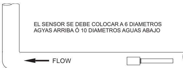
**DISPOSITIVOS INCREMENTADORES DE VELOCIDAD:** Codos, conexiones de bridas y “tes” tienden a introducir condiciones indeseables en un flujo distribuido laminarmente con entradas de aire o gases. Ubicar el sensor a 6 diámetros antes y 10 diámetros después de estas perturbaciones resulta ser generalmente lo más óptimo.
