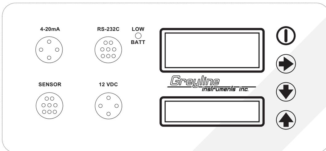
Un juego de cables y acoples son suministrados con cada PDFM-IV. Los acoples eléctricos o conectores son cableados en fábrica y etiquetados para que correspondan con los conectores hembra del panel frontal.
