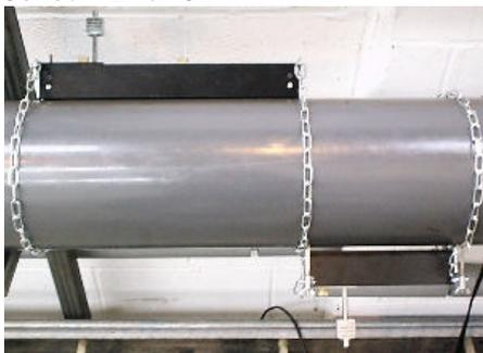
**Figura 11** – Montaggio tipo Reflex per Set Sensori 'D'
