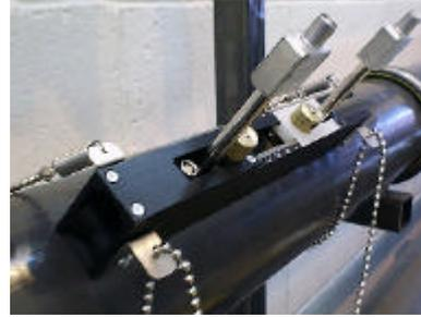
Per tutti i tubi piccolo sotto gli 89mm, usare i sensori da 2MHz, il quantitativo di accoppiante deve essere di almeno 20mm di lunghezza e 2mm di diametro massimo per il blocco sensore regolabile, mentre per il blocco sensore fisso deve essere di 30 mm di lunghezza e 2mm di diametro. Usando più accoppiante si potrebbero verificare falsi segnali che causerebbero errori di misura.
