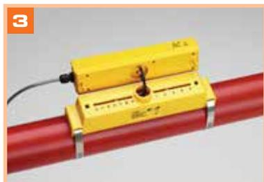
3 Connecter l'alimentation et les capteurs à la partie électronique de l'assemblage
